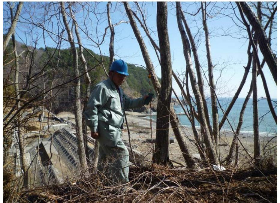
\* 測定起点は女遊漁港岸壁面(測定時1.33 m. トータルステーションは堤防面に設置(MSL 7.859 m(測定時潮位補正済み). 雑草流跡・堆積物に基づく.
