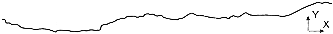
図7 稲田花崗岩中のGrain面に平行な一軸引張割れ目の断面（藤井ほか，2005）
