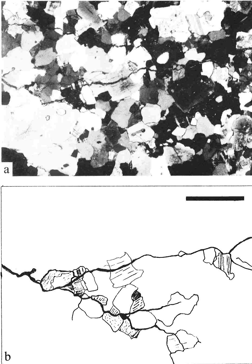
図9. 図8の中央やや右よりの拡大写真(a)とそのスケッチ(b). 枝分かれして幅の狭くなった節理は、粒子境界や粒子中のマイクロクラックを伝わりながら終点を迎える。右下の節理は長石と石英粒子の境界で終点を迎えており、その上の節理は長石中のマイクロクラックに収斂して終点を迎えている。写真はクロスニコル。スケールは1mm.
