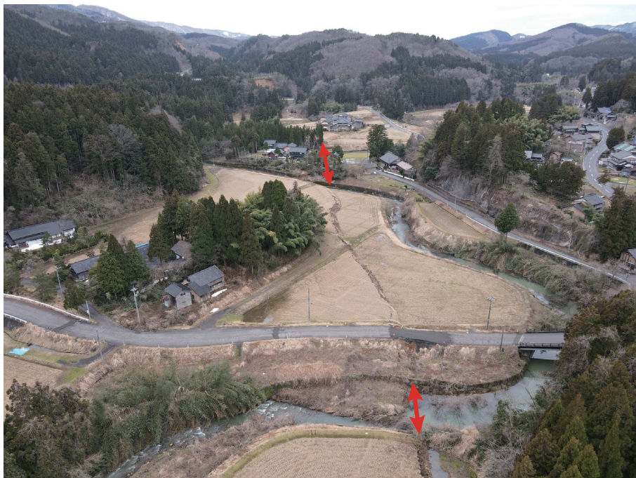
写真7 若山川河谷に沿ってLoc.1から西方に連続する地震断層。赤矢印が地震に伴う地形面変位の位置。
