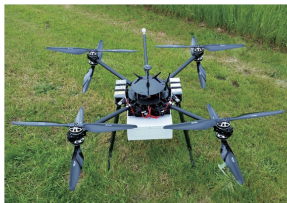
図2 ドローン搭載型メタンガス測定システム (LBNL Biraud 博士より写真提供)。
