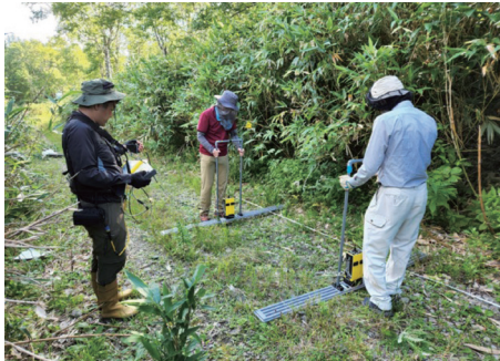
図 14 地中レーダー探査の様子 (上幌延北進線林道)。
