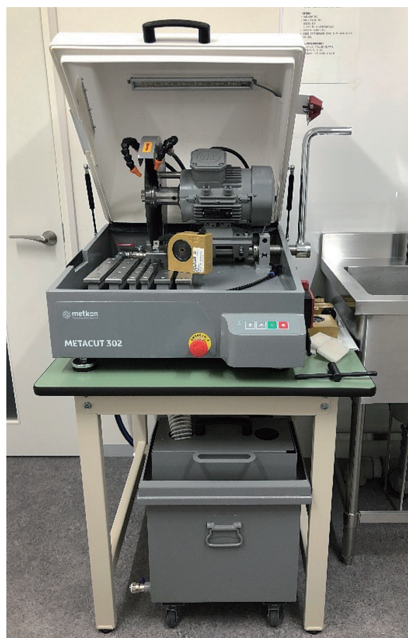
図 1 岩石カッター（METACUT 302）の設置状況。本体は 750mm 四方の汎用作業台に載せている。冷却水用のタンクは作業台の下に設置している。
