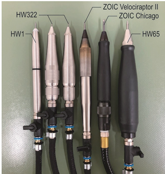
図2 エアチゼル各種。左の機種ほど、繊細な作業に適している。
