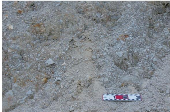
写真9 湖成堆積岩起源の破碎岩。
