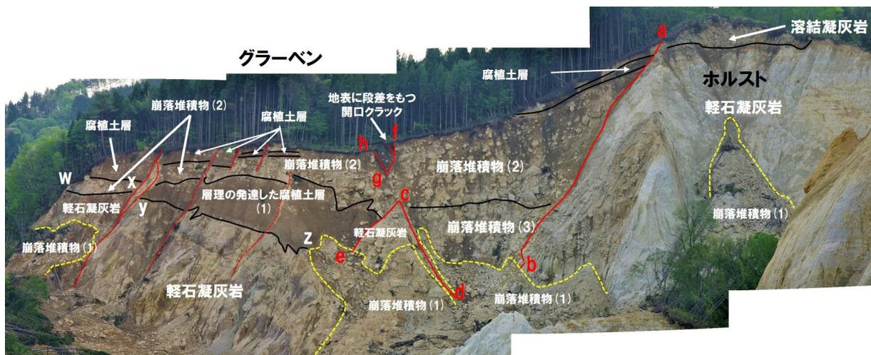
写真1 古荒砥沢 W スプレッドのホルスト・グラーベンの地中内部構造。
