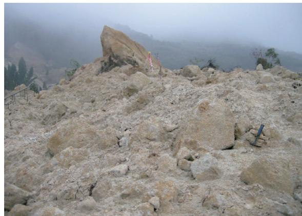
写真11 軽石凝灰岩起源の破碎岩。
