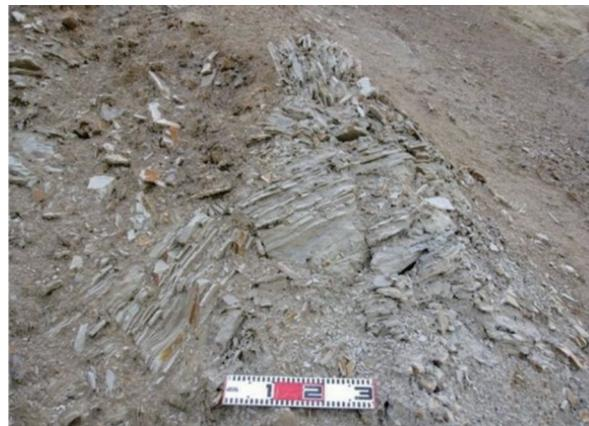
写真10 シルト岩優勢互層のブロックを含む湖成堆積岩起源の破碎岩。
