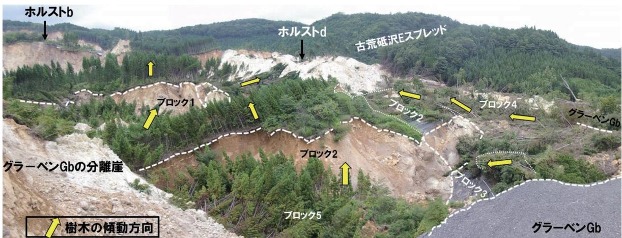
写真 8 グラーベン Gc 内部のブロック群の動き。
