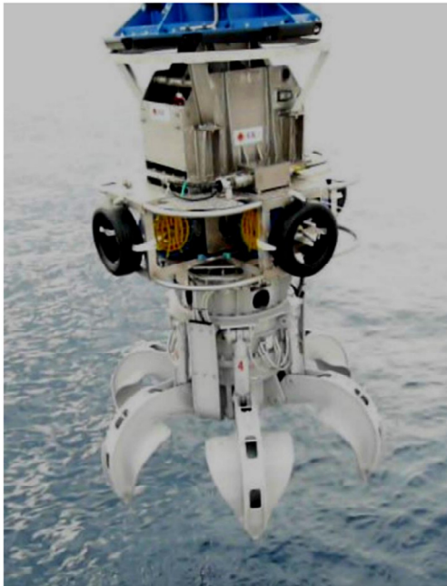
図 13 JAMSTEC の海底広域研究船「かいめい」搭載 6 本爪型パワーグラブ (PGC) の全体写真 (JAMSTEC, 2021). 最大深度 6000 m 対応で、採取容量 (バケット容積) 約 1 m 3 の岩石採取用巨大グラブ. BMS ウィンチに巻かれた光電気複合ケーブル (35.6 mmφ × 7000 m) を使用、搭載された 5 台の TV カメラで、海底を観察しながら、サンプリングが可能で、海底熱水鉱床調査 (例えば原口・児玉, 2007) に活用されている. 海底試料の大量採取には最適な装置であり、特にプチスポットマグマ由来のやや脆い火山角礫岩等の大量採取には、威力を発揮することが期待される.
