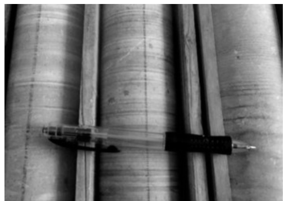
図 20 表面にビット削痕のあるコア
