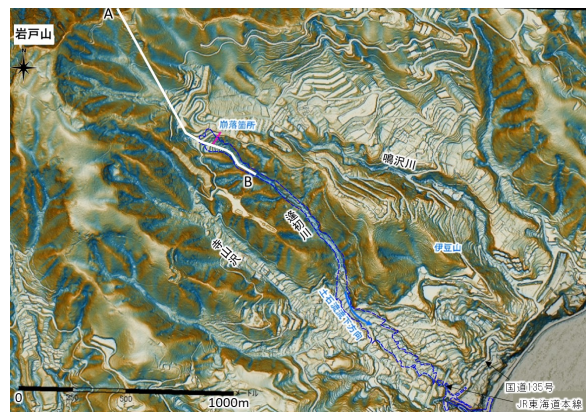
図 3 静岡県熱海市伊豆山付近の立体地図 (朝日航洋(株), 2021a) 2019 年 6 月 LP 計測データによって作成。図中に青破線は逢初川の土石流流下範囲を示す。
