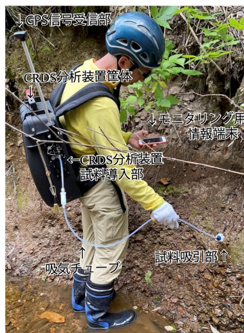
図 2 徒歩測定の様子。局所的に高いメタン濃度を示す箇所を試料吸引部を近づけている様子。
