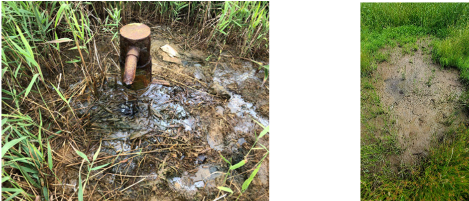
図 13 ペンケオートマップ川北側の牧草地にあるボーリング跡および泥部。(左) ボーリング跡 (図 10 の○)。口元から塩分濃度の高い水とガスの湧出を確認した。(右) 泥部 (図 10 の口)。大きさ約 1.5m×2.5m、中央左の水たまりから間歇的なガス湧出を確認した。
