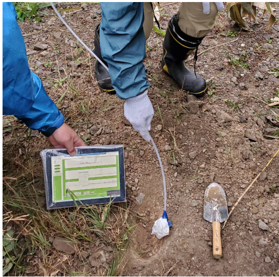
図7 上幌延北進線林道の地点X(図5参照)で地面の表土をスコップで剥いてインレットチューブを近づけている様子。8月8日の測定時に撮影。350 ppmに達する高濃度のメタンが検知された。
