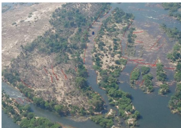
写真9 確認できる断層溝状凹地の谷壁をつくる段差地形．樹木で隠れているところ，写真の写りが不鮮明なところは省いた．赤色破線：段差地形の位置，赤色実線：断層，a：写真7～9の同一地点．
