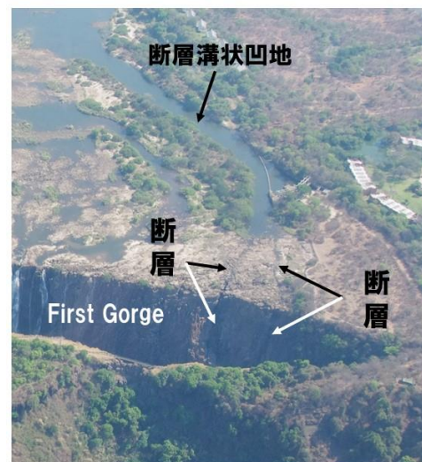
写真10 断層溝状凹地とその両谷壁を規制している断層．
