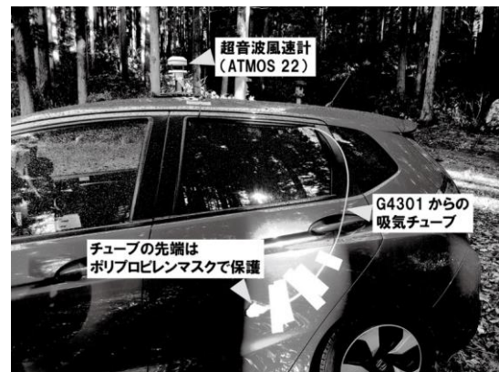
図4 車載測定の様子。自動車の後部座席にG4301を固定し、同装置に接続する吸気チューブの先端を車外に出して大気中メタン濃度を測定した。
