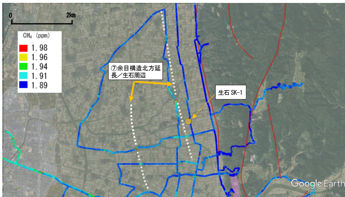
図 15 砂越油田周辺のメタン濃度分布（場所は、図 2 中の領域②北側，カラーマップ：狭域レンジ），ベースマップには，Google Earth を使用した。赤線は，産業技術総合研究所活断層データベースの「活動セグメント」を示す。白破線は，推定されるアノマリ列を示す。
