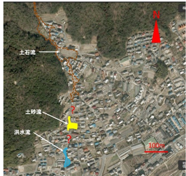
図1 緑井8丁目の団地を流れた山津波堆積物の分布。山津波は沖積錐の西端の谷型斜面に沿って流れている。地理院地図（電子地図 Web）：2004 年～（被災以前の簡易空中写真）に加筆。茶色破線：土石流堆積物，黄色着色：土砂流堆積物，水色着色：洪水流堆積物
