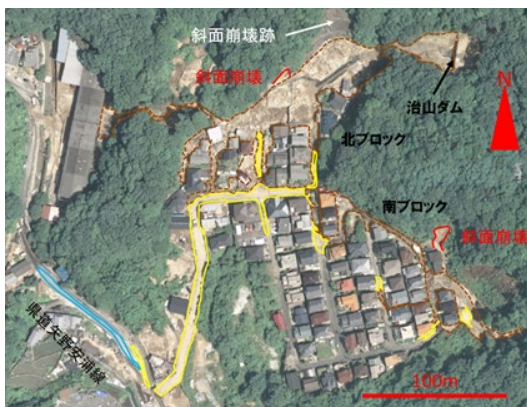
図5 梅河ハイツに堆積した山津波堆積物の分布。山津波は、空き地とアスファルト舗装道路上を流れている。土石流堆積物・流木・全壊した家屋は撤去されている。地理院地図（電子地図 Web）：2018 年空中写真（被災直後）に加筆。茶色破線：土石流堆積物、黄色実線：土砂流堆積物、水色実線：洪水流堆積物
