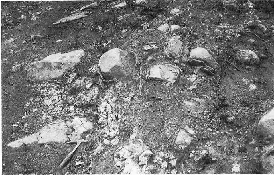
写真-2 玉葱状構造をもつ風化帯（左側方崖背後の斜面）
