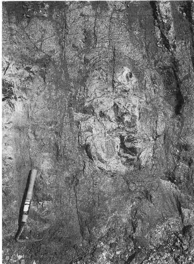
写真-3 赤褐色風化帯中の赤色流入粘土脈（右側方崖背後）
