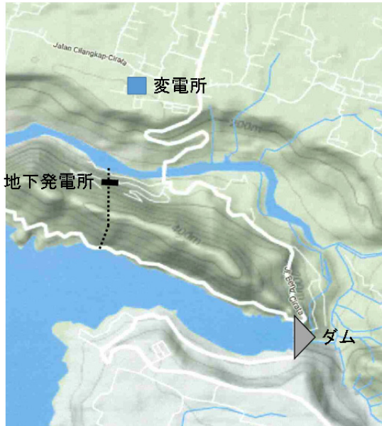
図7 建設地点地形と構造物配置
