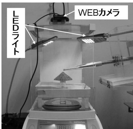
図1 写真撮影のための装置。WEBカメラと2個のLEDライト。
