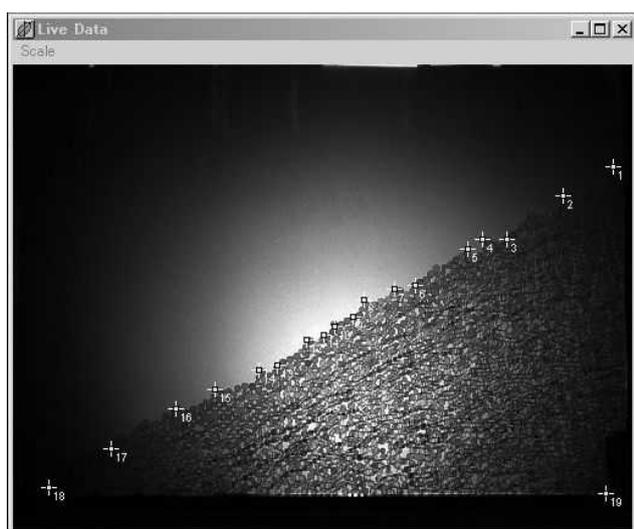
図4 不要部分の排除のための座標の読み取り。+印が読み取った座標（19点）で、これを結んだ外側の領域に位置するピクセルは無視される。
